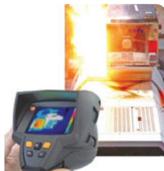
Olajköd-leválasztó a robbanási teszt és a lángátütés teszt során
