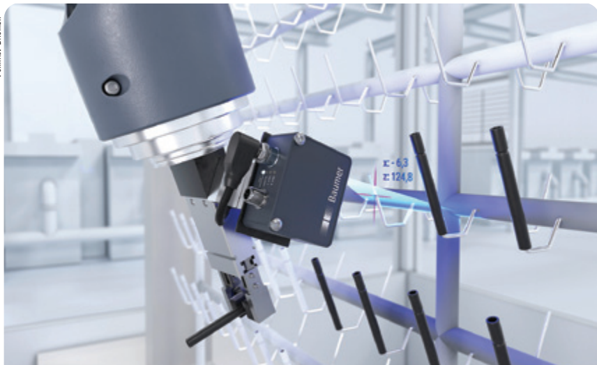
Az OX sorozatba tartozó intelligens 2D profilérzékelők mindenhol bevetethetők, ahol a pozicionálási feladatokban magasságmérésre van szükség. A képen látható alkalmazásban az OXM200 pontos pozicionálási adatokat szolgáltat egy robotnak, amely munkadarabokat helyez a galvanizálóállványra
