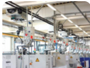
Ultra kompakt elektrosztatikus olajköd-leválasztók Schütte automata esztergagépeken
