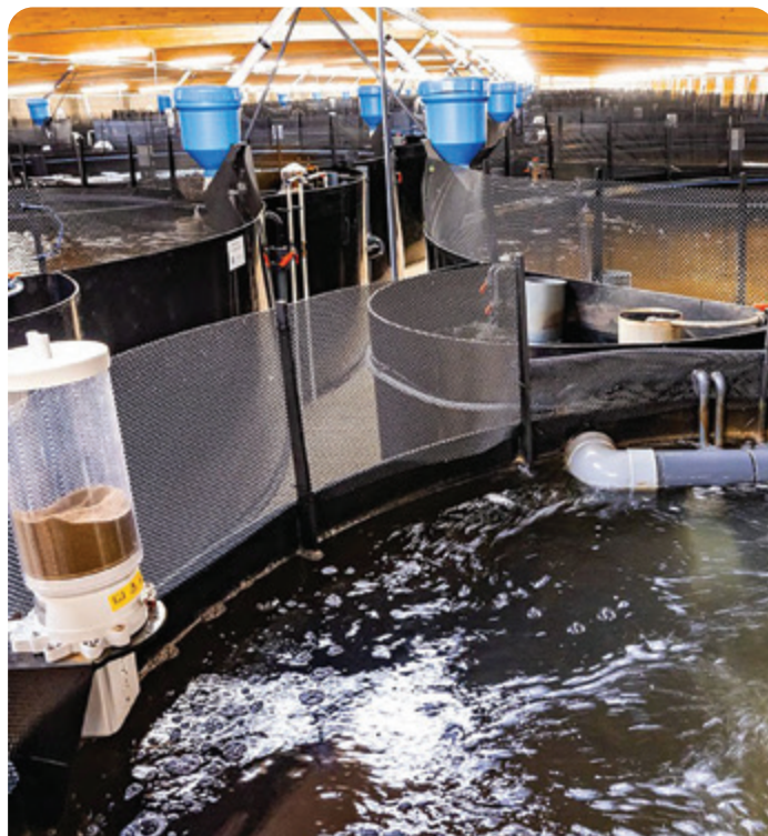
Az 56 garnélatartályban számos paramétert állandó értéken kell tartani, és pontosan szabályozni kell az áramlási és takarmányozási mennyiségeket
