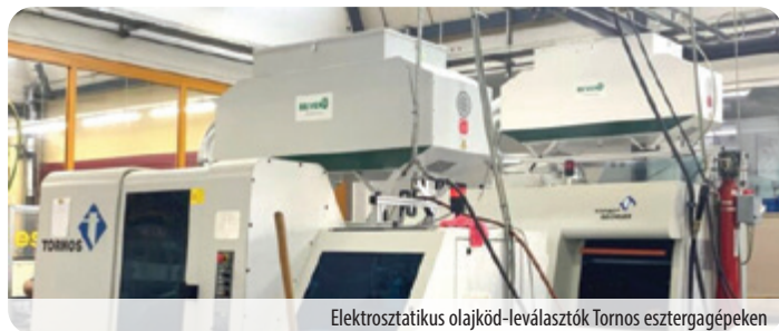
Elektrosztatikus olajköd-leválasztók Tornos esztergagépeken
