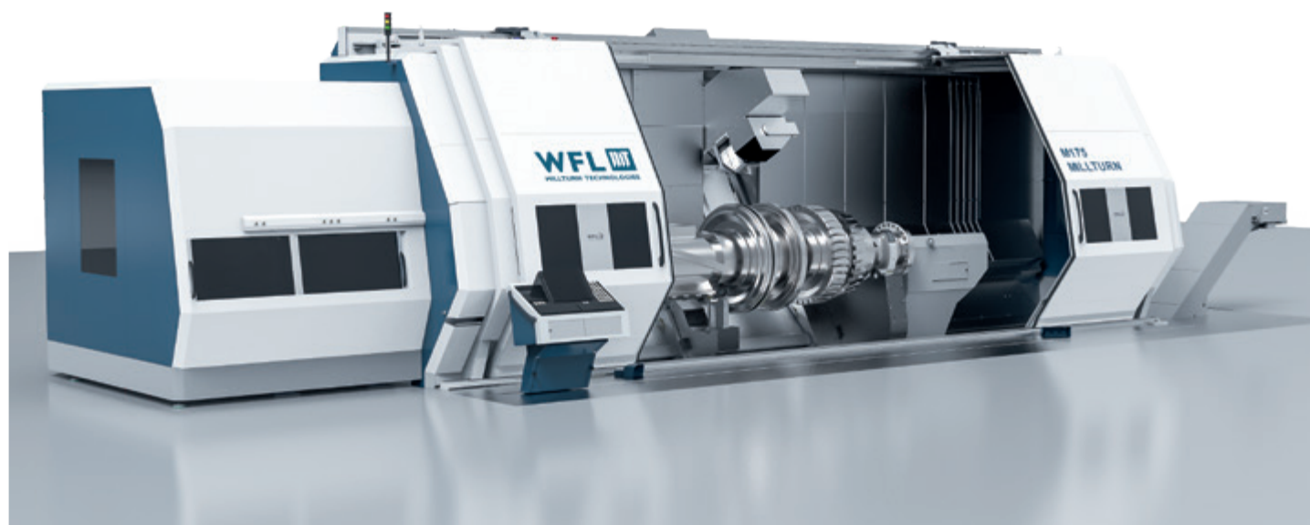
Az M175 MILLTURN a komplex maró-, fúró- és esztergálóműveleteket is kivételes pontosság mellett végzi el – még nagy méretű munkadarabok esetében is
