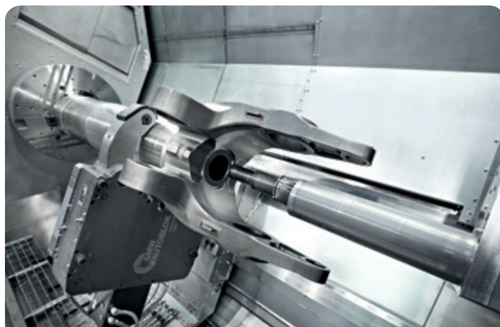
Az M175 MILLTURN figyelemre méltóan változatos alkalmazási spektrummal rendelkezik – többek között repülőgépfutómű-szerkezetelemek megmunkálására is képes
