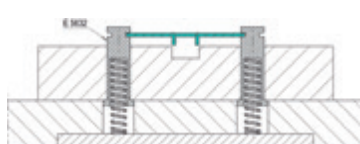
Beépítési példa – rugós vállas sávvezető
