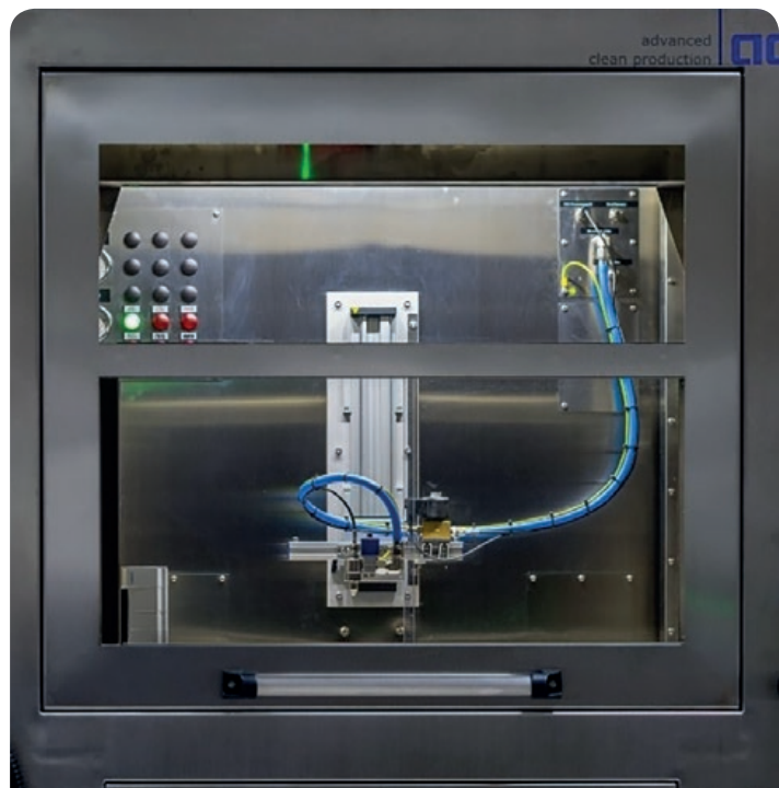
A teljesen rozsdamentes acélból készült rendszerrel a tisztítandó alkatrészt egy, a folyamatkamrában található fogadóegységre helyezik, amit egy x/y tengelyre, körasztalra vagy a kettős kombinációjára szerelnek.
