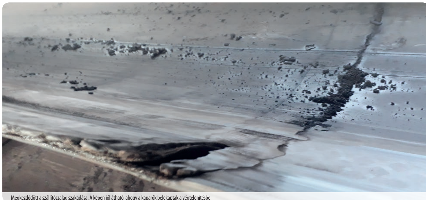
Megkezdődött a szállítózsalag szakadása. A képen jól átható, ahogy a kaparók belekaptak a végtelenítésbe
