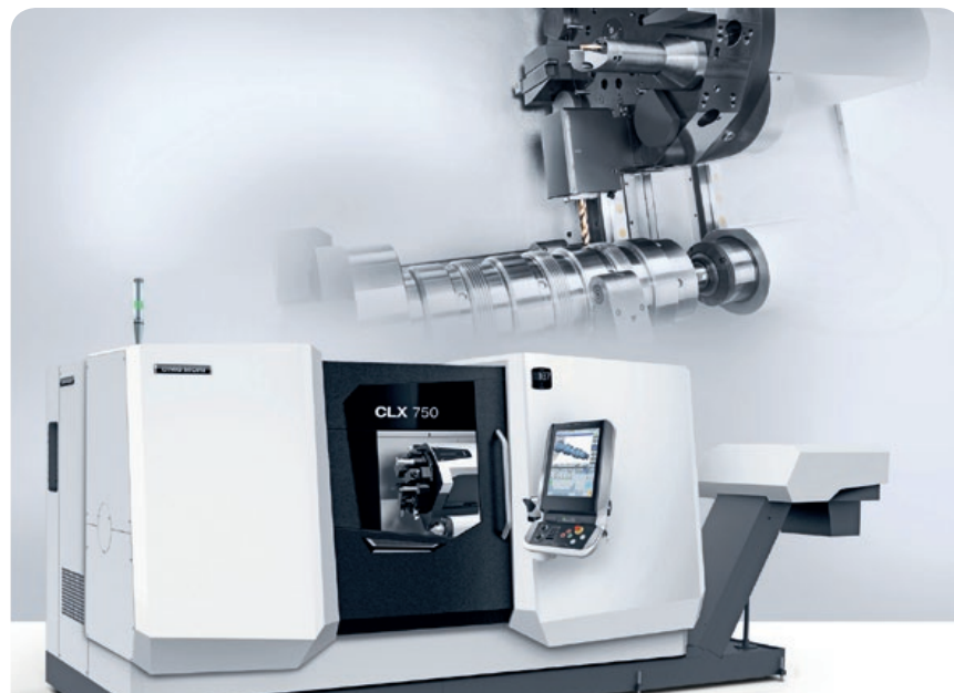
A DMG MORI az EMO kiállításon tartotta a CLX széria új csúcsmo­delljének számító CLX 750 világpremierjét. A gépet maximum 600 kg-os alkatrészek 8,9 m 2 alapterületen történő megmunkálására tervezték
