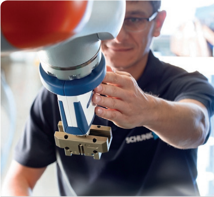
Amint a dolgozó befejez egy összeszerelési feladatot, egyetlen érintéssel jelzi ezt a robotnak, a robot pedig felveszi az elkészült komponens
