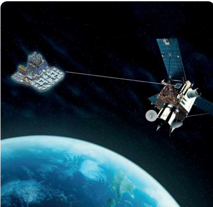
A TRUMPF nyomtatta a német Heinrich Hertz hírközlési műhold mikrohullámú szűrőinek keretét, ami 55 százalékos súlymegtakarítást eredményezett
