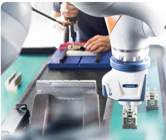
Amíg az operátor összeszereli a megfogószervezetet, addig – azaz a kézi szereléssel párhuzamosan – a robot más feladatokat végezhet, így például az alkatrészek adagolását vagy éppen a komponensek sorjázását
