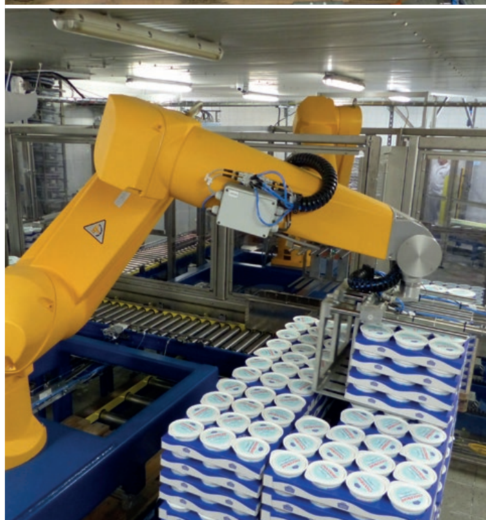
Két hattengelyes RX160 robot palettázza a tálcák 4 doboz magasságú csomagjait. A raklaponkénti hat réteg teljes terhelése összesen 1 728 doboz
